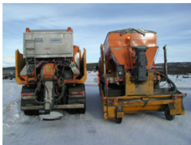
写真-1 加熱水混合式散布車（ノルウェー）、 [参考文献4)「Nordic Road & Transport Research 2001」より出典]
