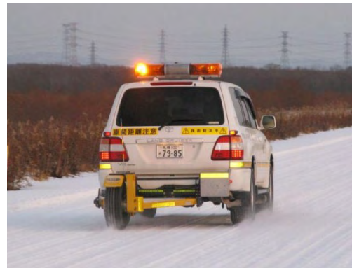
写真-4 連続路面すべり抵抗値測定装置
