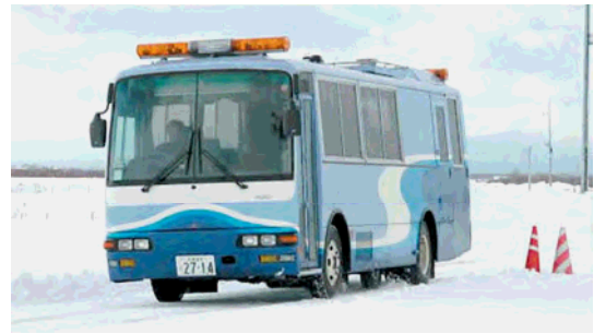
写真-3 すべり試験車
