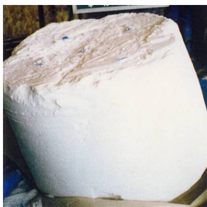
写真-6 塩化ナトリウム固結状態
