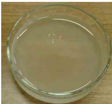
写真-3 凍結防止剤水溶液の凍結状態の例 (塩化ナトリウム3%、試験温度-10°C、試験時間120分)
