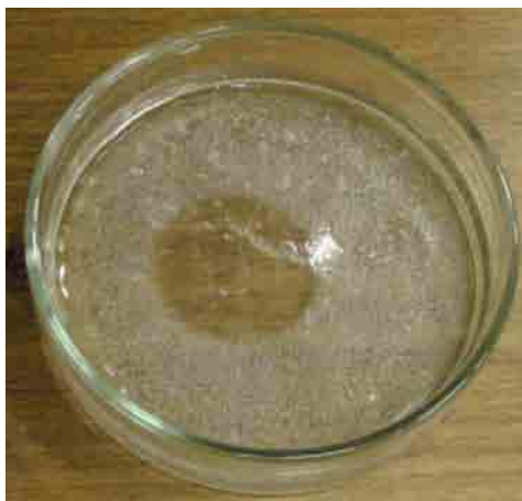
写真-1 水の一部凍結状態 (試験温度-10°C、試験時間120分)
