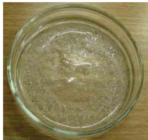
写真-2 水の完全凍結状態 (試験温度-10°C、試験時間24時間)
