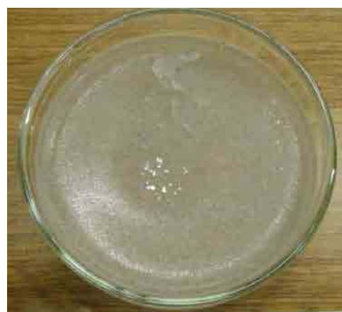
写真-4 凍結防止剤水溶液の凍結状態の例 (塩化ナトリウム3%、試験温度-10°C、試験時間24時間)
