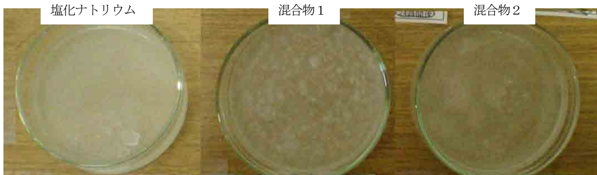
写真-7 重量濃度 3% における塩化ナトリウムと混合物の凍結状態 (試験温度 -10^{\circ}\text{C} 、試験時間 24 時間)
