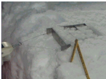
写真-8 ④デジタルフォースゲージによりシアーフレームを引っ張り剪断させ、その最大値を読み取る。
