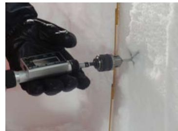
写真-11 ③ベーンを回転させる
