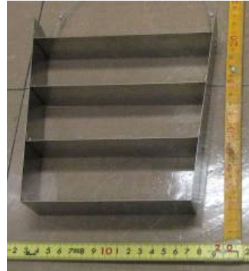
写真－3 シアーフレーム試験器
