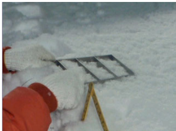
写真-6 ②測定層にシアーフレームを設置する
