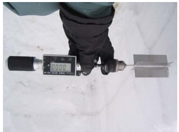
写真－4 ベーン試験器の外観
