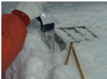
写真-7 ③シアーフレームの周りの雪を取り除く
