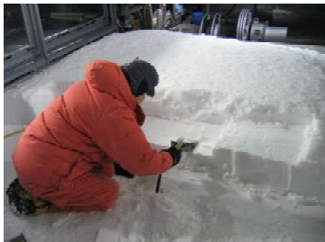
写真-5 ①測定層を掘り出し整形する
