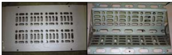
写真-6 計測板(左:平板、右:折板) \varepsilon=30\%
