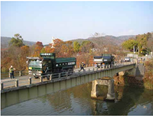
写真-3 20tトラックによる静的荷重載荷状況
