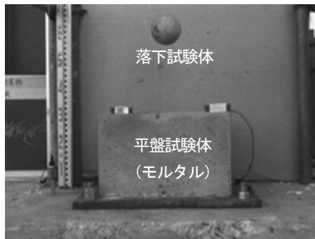
写真-1 屋内実験状況（自由落下試験）
