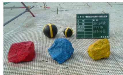
写真-3 現地落石実験の落石岩体試験体
