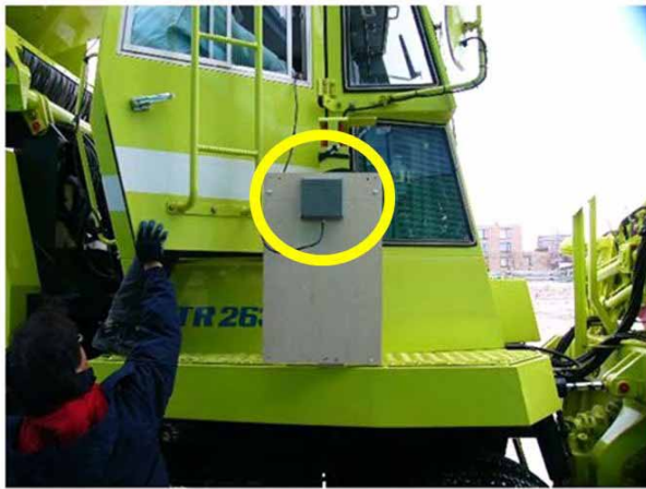
写真-7 RFIDアンテナ
