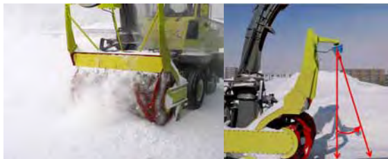
写真-6 雪の飛出しとレーザ角度
