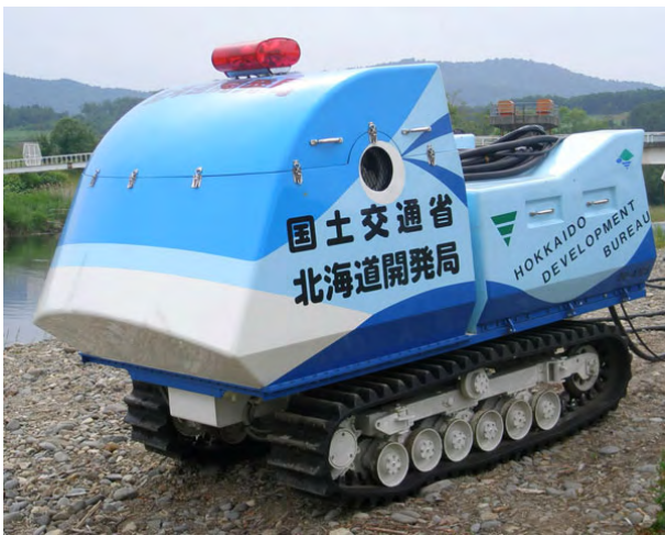
写真-3 既存ポンプ自走装置外観
