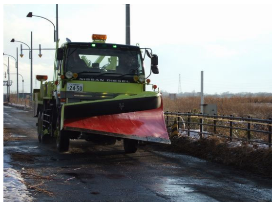
写真－11 除雪トラック加速試験状況
