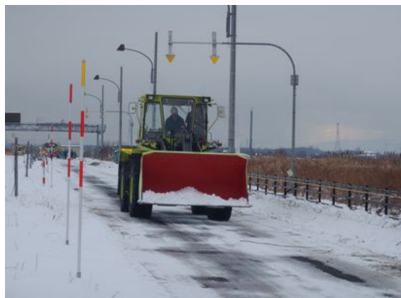
写真－10 除雪ドーザ加速試験状況
