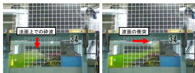
写真-3(2) 波の作用状況 (断面⑤)
