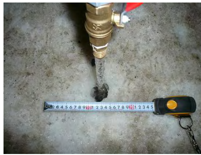
写真-3 水の注入による縦穴の形成
