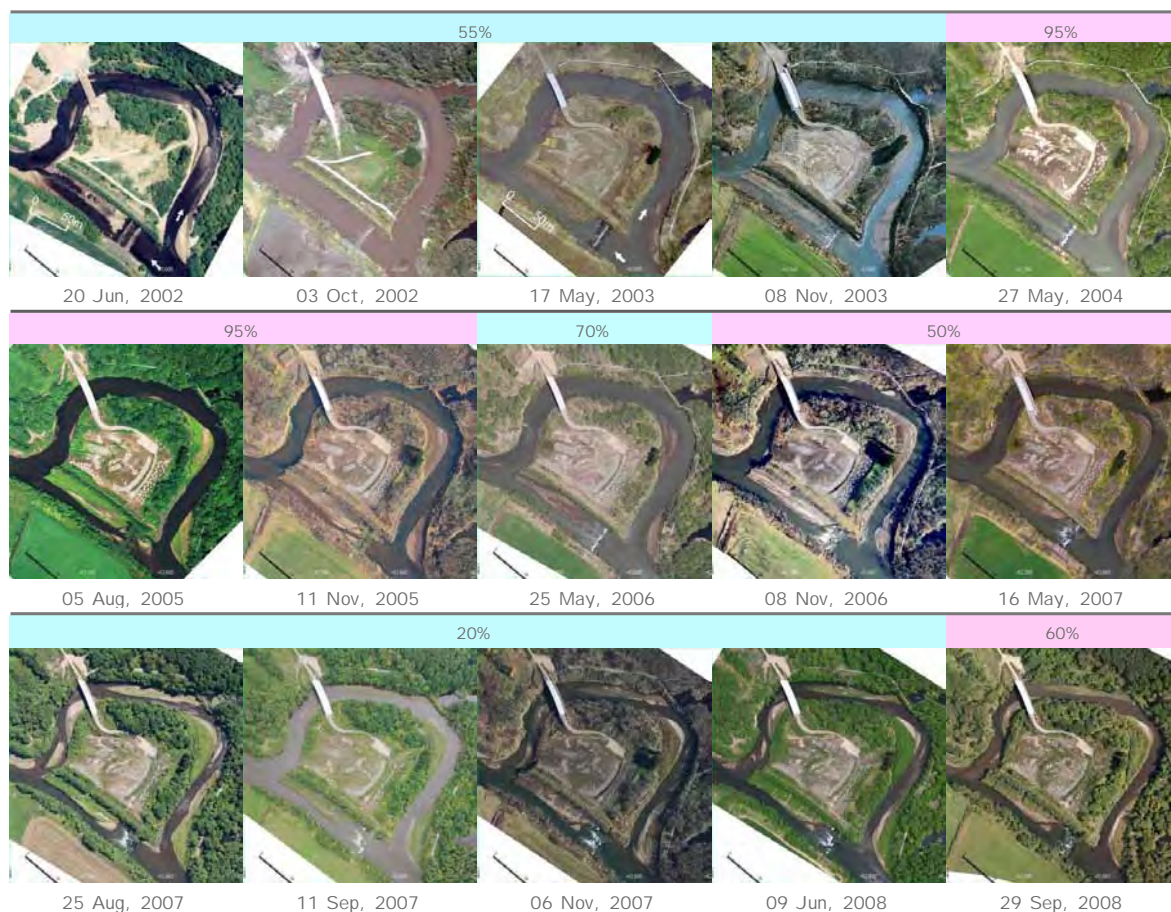
図-6 蛇行復元試験区間の疑似垂直化写真とその時期の蛇行部における流量配分比（上段）
