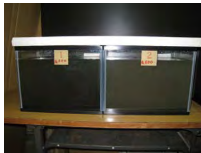
写真-7 底質を投入した直後の水槽
