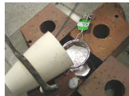
Fig. 4(b) アルミニウムと電池滓の分離
