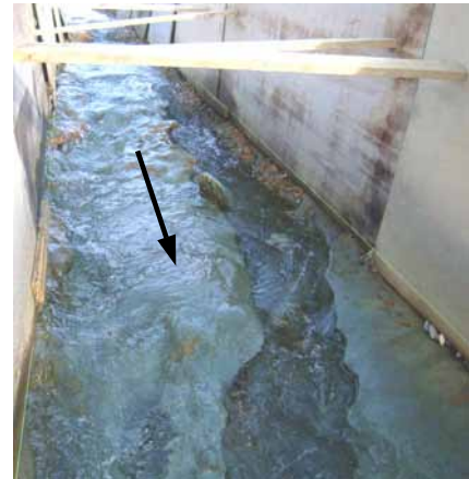
写真-4 実験終了後の水路 (おう穴、みずみちの形成)
