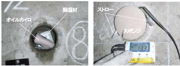
(a) オイルカイロと除湿材 (b) 孔内温度
