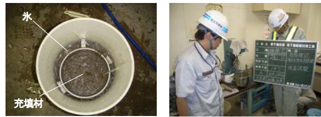
(a) 氷を用いた低温試験 (b) 練混ぜ温度確認状況
