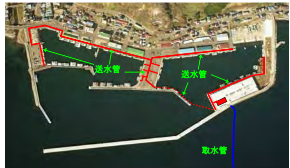
写真-3 低温清浄海水（深層水）取水施設の配置
