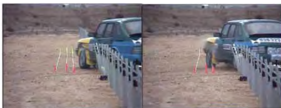
写真-3 ワイヤーロープ式防護柵の衝突実験状況 3)
