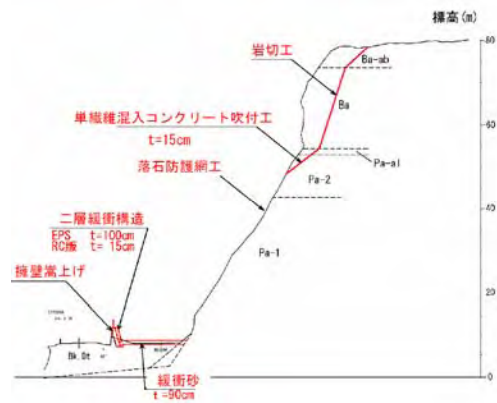
図-5 幌地区対策工概略断面図
