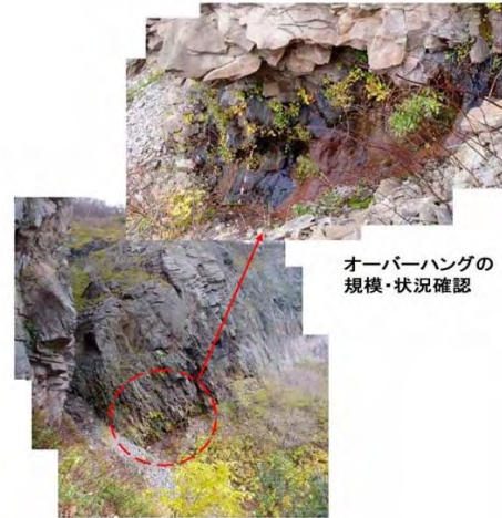
写真-9 タンパケ地区 H17 撮影 溶岩-火砕岩境界部の湧水、浸食状況
