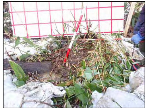
図-8 根鉢が不明瞭な試験木(護岸上、土砂堆積厚 90cm)
