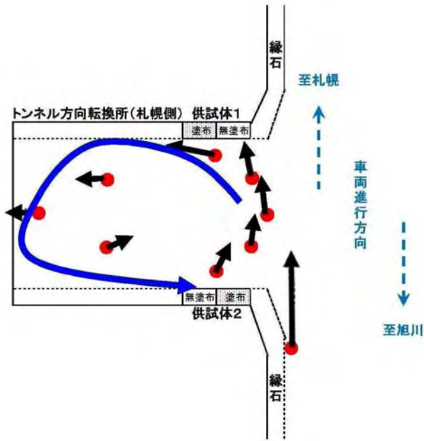
図-7 方向転換所の風の流れ
