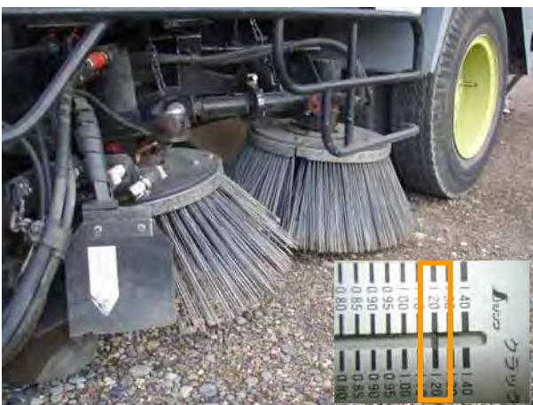
写真-19 平鋼線材タイプ (t=1.2mm×L=700mm) ブラシ
