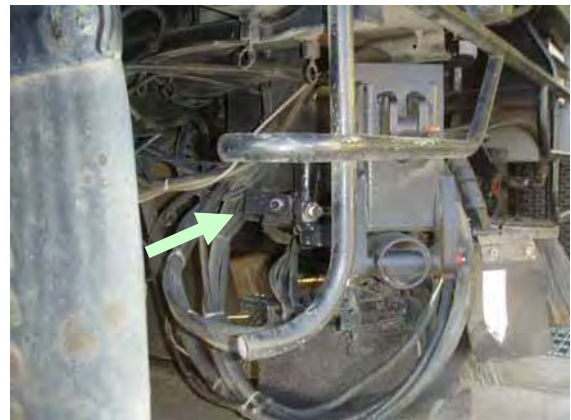
写真-11 アーム張り出し変更
