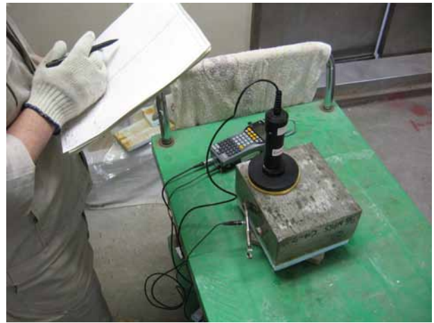
写真-1 腐食速度の測定状況
