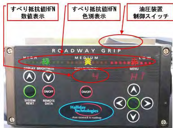
写真-3 表示・制御装置（前面）
