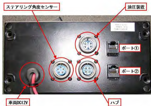
写真-4 表示・制御装置（背面）
