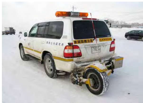
写真-1 連続路面すべり抵抗値測定装置全景
