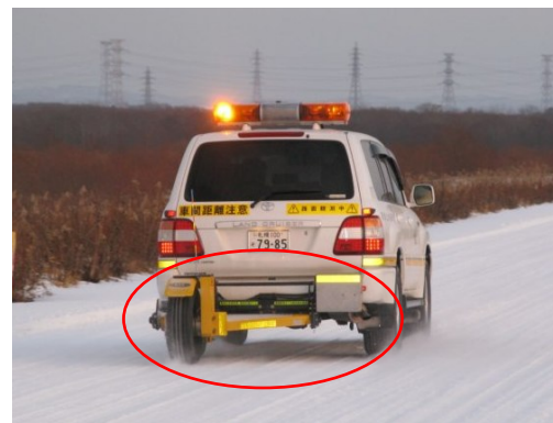
写真-2 連続路面すべり抵抗値測定装置
