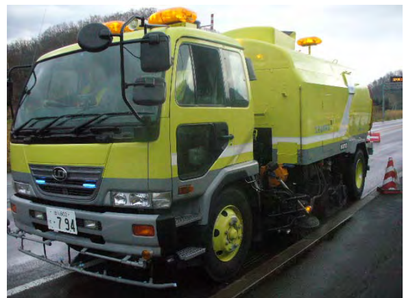
写真-10 真空式路面清掃車による清掃状況
