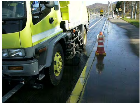
写真-9 4 輪ブラシ式路面清掃車による清掃状況
