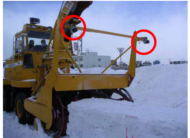
図-5 レーザースキャナ取付状況 (雪切板先端部)
