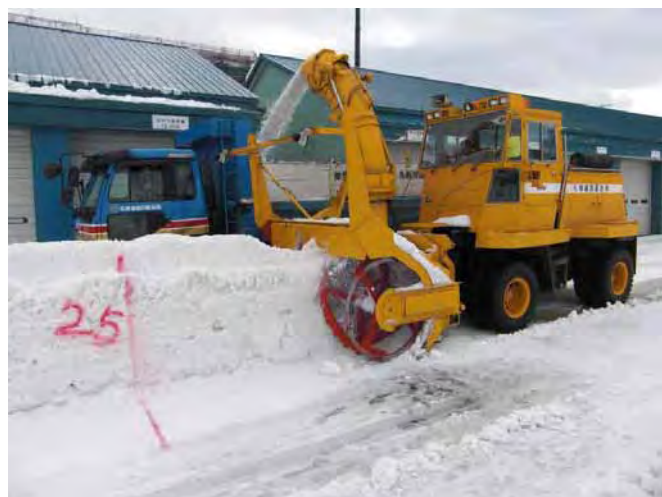
図-14 雪堤・除雪状況（高雪堤）
