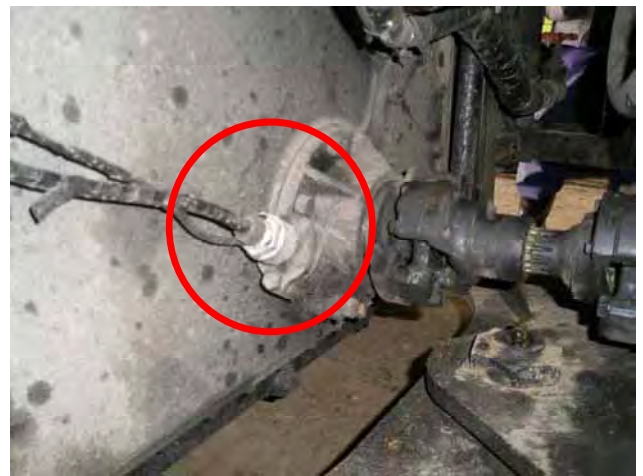
図-6 パルスデータ取得状況 (車軸部)
