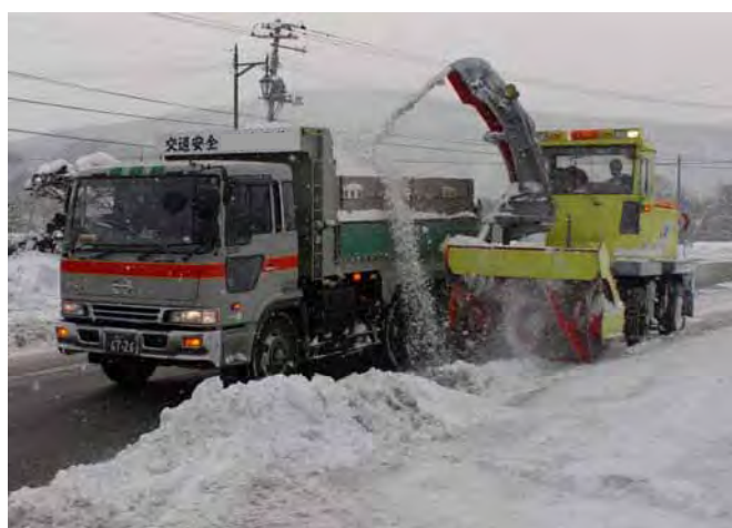
図-1 運搬除雪作業状況（並列）
