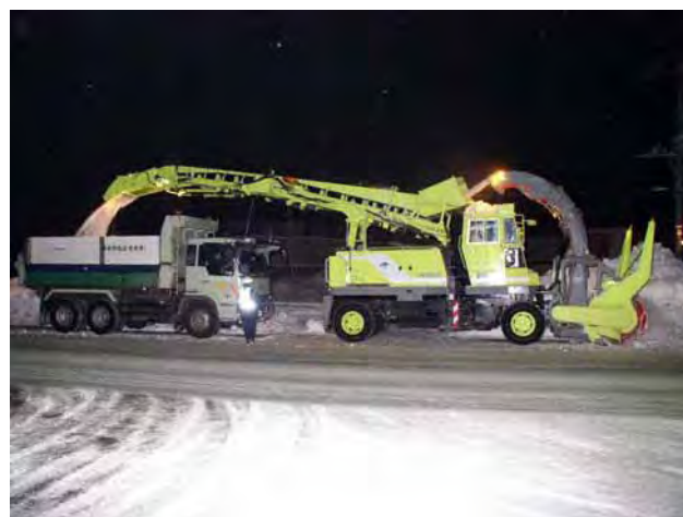
図-2 運搬除雪作業状況（縦列）
