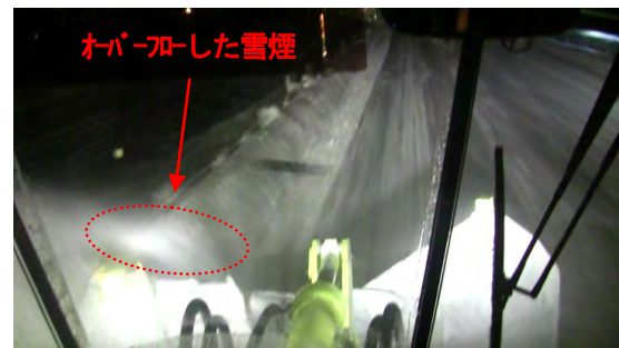
写真-14 オーバーフローした雪煙状況
