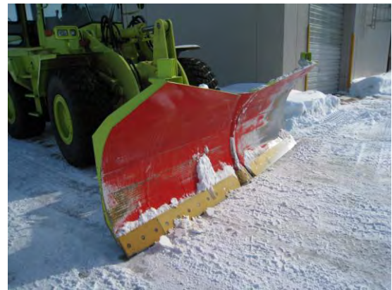
写真-3 除雪ドーザ用マルチブレード（3番車用）
