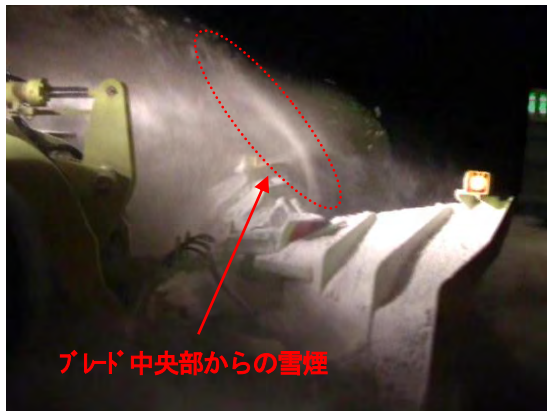
写真-13 ブレード中央部からの雪煙
