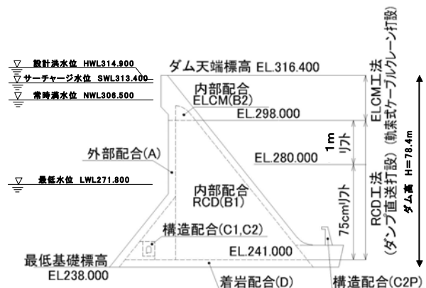
図-2 ダム標準断面図、配合区分図
