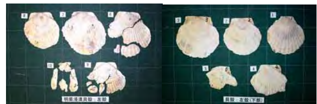
写真-4 附帯明渠浸漬貝殻と疎水材下層部貝殻の比較 (左：附帯明渠浸漬貝殻、右：ホタテ貝殻区下層部左殻)
