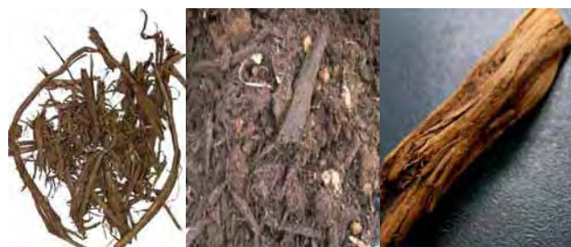
写真-5 施工後2年目、11年目の埋木チップ形状 (左: 施工後2年目 1) 、中: 施工後11年目、右: 施工後11年目拡大図)
