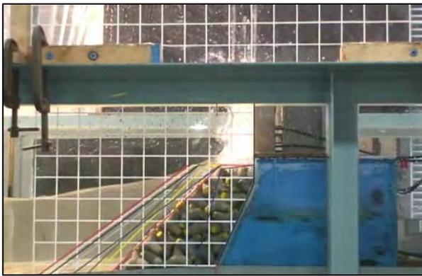
写真-5 波圧実験状況の例 (A護岸)
