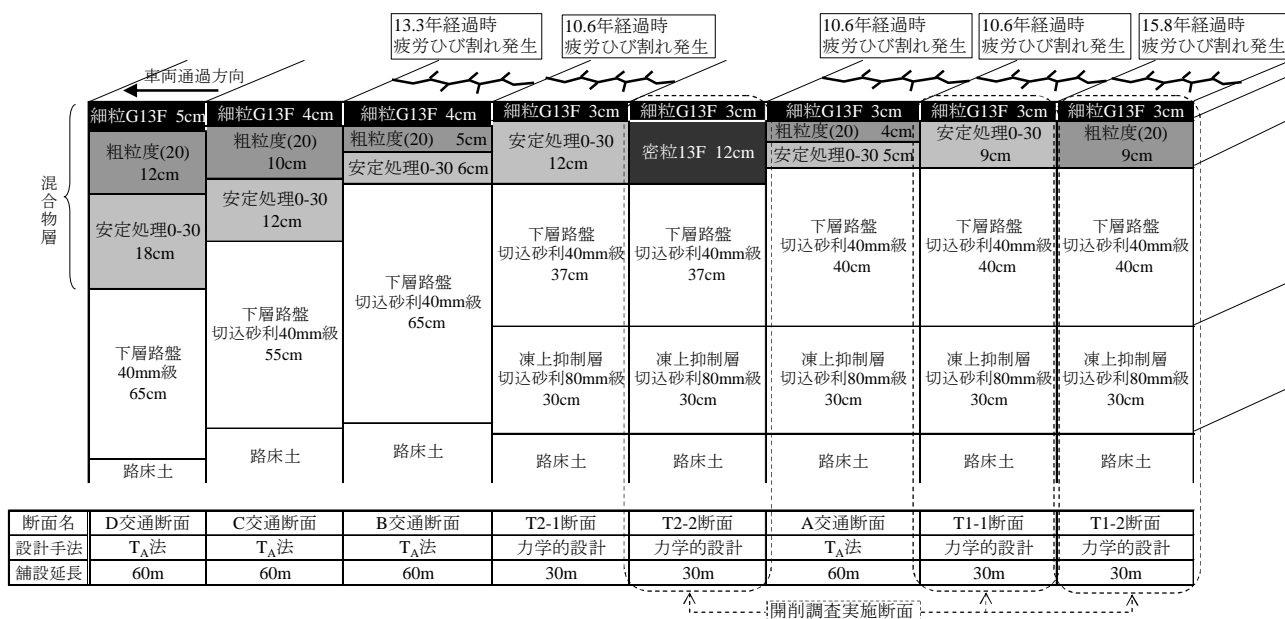
図-1 美々新試験道路の舗装断面および疲労破壊状況
