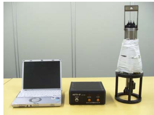
写真-2 Compact-CTD計（右）とインターフェイス（中）
