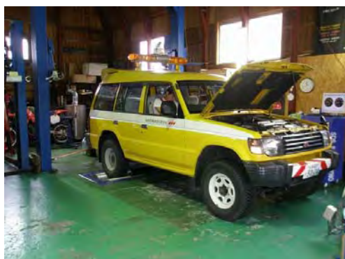
写真-1 シャシーダイナモメータによる馬力・トルク計測状況
