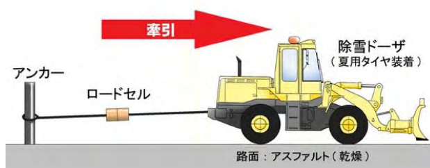
図-9 牽引力試験概要図
