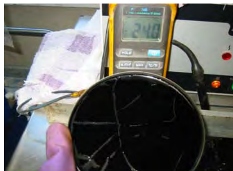
写真-1 熱応力によるアスファルトの破壊
