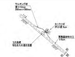
図-9-②苗木設置吹きつけ工概要図
