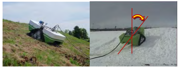
写真-12 登坂試験状況
