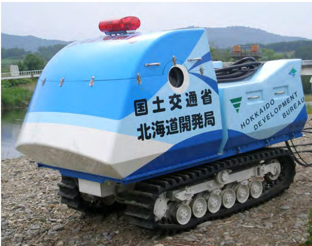
写真-2 既存ポンプ自走装置
