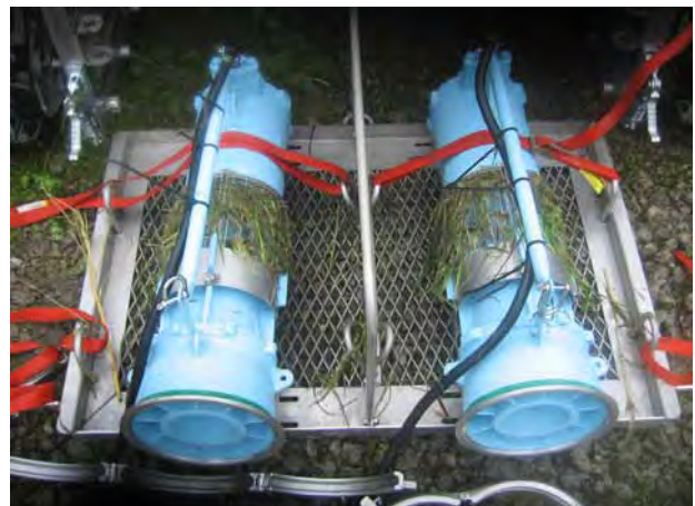
写真-14 草の吸い込み状況
