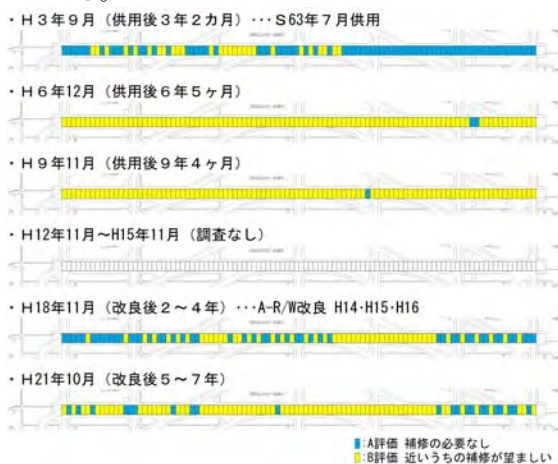
図-11 A滑走路におけるひび割れ率の推移
