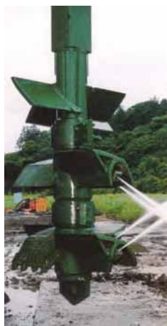
写真-1 JACSMAN 攪拌翼と噴射状況
