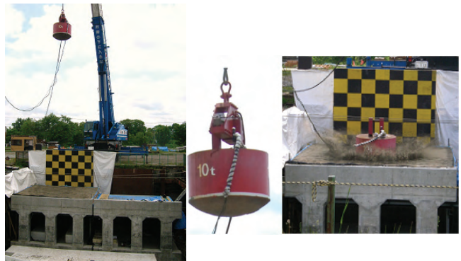
写真-1 重錘落下衝突実験状況
