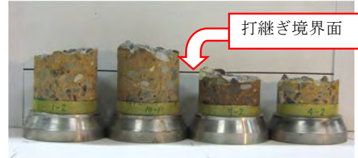
基準供試体 WJ工法 EP工法 CB工法
