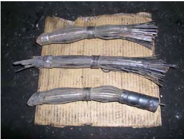
写真-14 折損、脱落した鋼線式ブラシ
