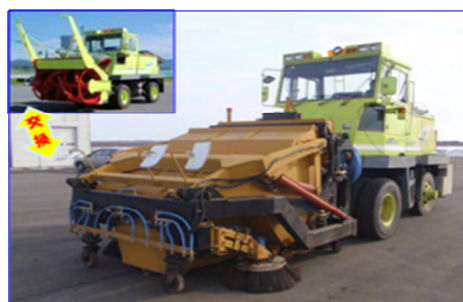
写真-1 ロータリ除雪車に対応した路面清掃装置（試作機）
