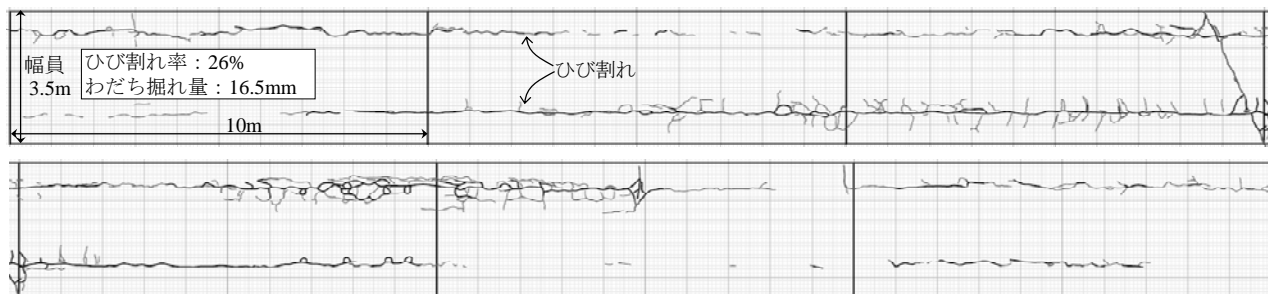
図-8 補修前の路面の疲労ひび割れ状況(幅員3.5m、延長60m区間)
