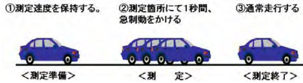
図-1 加速度計計測方法
