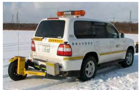
写真-3 連続路面すべり抵抗値測定装置 (CFT)
