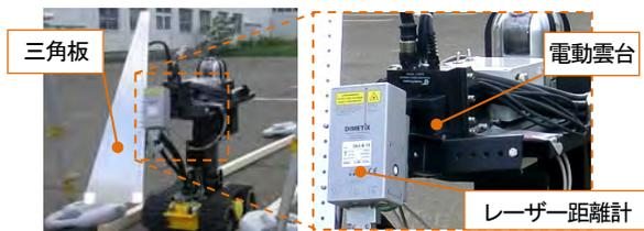
写真-3 変位計測装置
