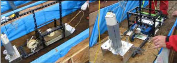
写真-8 模擬空洞探査試験状況 (左: 樋門用、右: 陸上用)
