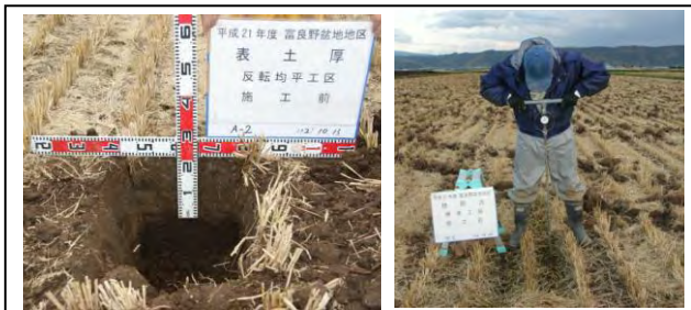
図-4 表土調査状況（左：表土厚測定、右：地耐力測定）
