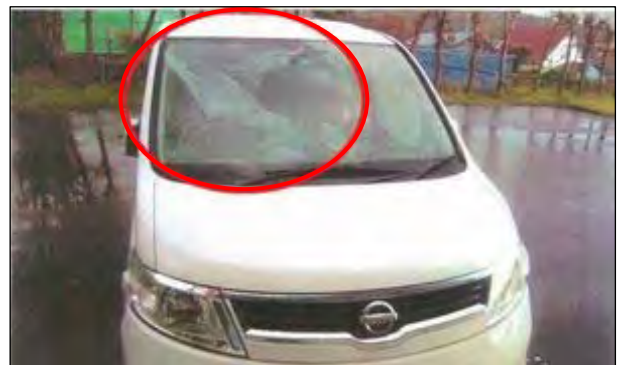
写真-2 越波によって被災した車両
